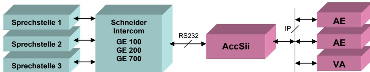
Auf der einen Seite ist AccSii über eine serielle Schnittstelle (RS232) mit der Schneider Intercom Anlage verbunden, auf der anderen Seite kann AccSii über IP beliebig viele Video-Arbeitsplätze (VA) oder Anzeige-Einheiten (AE) steuern.
