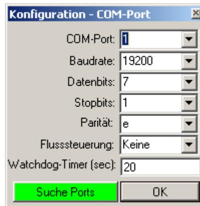
Nehmen Sie hier bitte alle nötigen Einstellungen für die serielle Verbindung zur Schneider Intercom vor. Die passenden Verbindungsparameter entnehmen Sie bitte der Dokumentation Ihrer Schneider Intercom Anlage.
