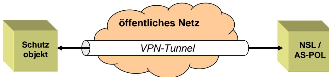
Ein VPN ermöglicht auf diese Weise auch über öffentliche Netze Datenverbindungen, so als ob die Teilnehmer direkt miteinander verbunden wären; die Einflüsse des öffentlichen Netzes werden durch die VPN-Technologie abgeschirmt.
