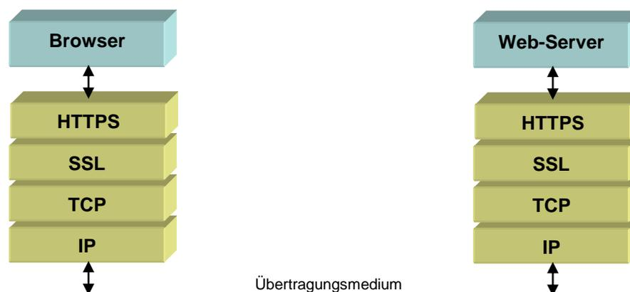
SSL nutzt Verschlüsselungs-Algorithmen wie z.B. AES, IDEA, RSA und Triple DES. Die aktuelle Weiterentwicklung von SSL heißt TLS (transport layer security).
