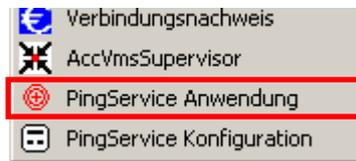
AccPingExe ist eine eigenständige dialogbasierte Windows-Anwendung. Sie liest vom EBÜS System eine Liste von IP-Adressen und zugehörigen Ping-Intervallen ein und führt dann entsprechend dieser Liste Ping Anfragen durch. Zusätzlich kann eine Datei angegeben werden, aus der weitere zu überwachende IP-Adressen ausgelesen werden. Die Vorgehensweise wird im Kapitel 6 (Technische Details) genauer erläutert. Nach dem Start wird folgender Dialog angezeigt:
