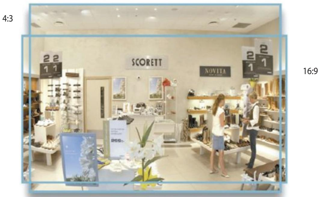
Die Megapixelauflösung ist ein Bereich, in dem Netzwerkkameras analogen Kameras überlegen sind. Die maximale Auflösung, die eine herkömmliche analoge Kamera bieten kann, nachdem das Videosignal von einem digitalen Videorecorder oder einem Video-Encoder umgewandelt wurde, ist D1, was 720 x 480 Pixeln
