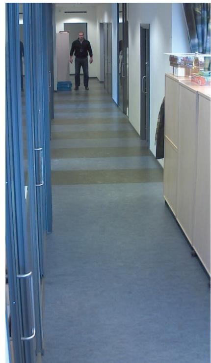
Bei besonderen Anwendungsfällen, wie zum Beispiel in Fluren oder bei einer Zaunüberwachung, setzt sich auf Grund einer effektiveren Ausnutzung des Sensors das Seitenverhältnis 9:16 immer mehr durch. Dies hat den Vorteil, dass die zu erfassende Szene effektiver abgebildet werden kann.
