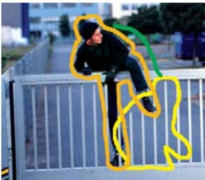
**(4) MOTION ANALYSIS:** Die Bewegungen der Objekte werden errechnet, indem Umrisse der Objekte in aufeinander folgenden Bildern verfolgt werden. Laufen sie in eine kritische Richtung?
