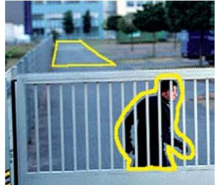
**(3) TEXTURE ANALYSIS:** Durch statistische Analyse werden nicht relevante Veränderungen, wie sie z.B. durch Niederschlag oder veränderte Beleuchtungsverhältnisse entstehen, herausgefiltert.
