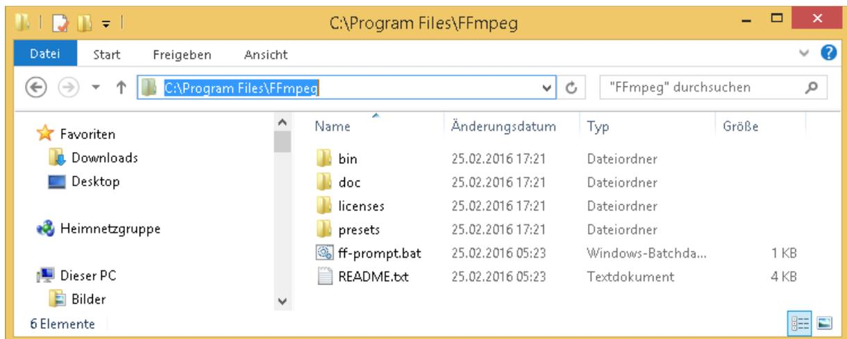
Nun muss der Pfad auf das bin-Verzeichnis in die Windows-Environment-Variablen „Path“ eingetragen werden. Dahin kommt man über die Windows „Systemsteuerung“ → „System“ → „Erweiterte Systemeinstellungen“ → „Umgebungsvariablen“ → „Systemvariablen“ → Systemvariable „Path“ wählen → auf „Bearbeiten“ klicken:
