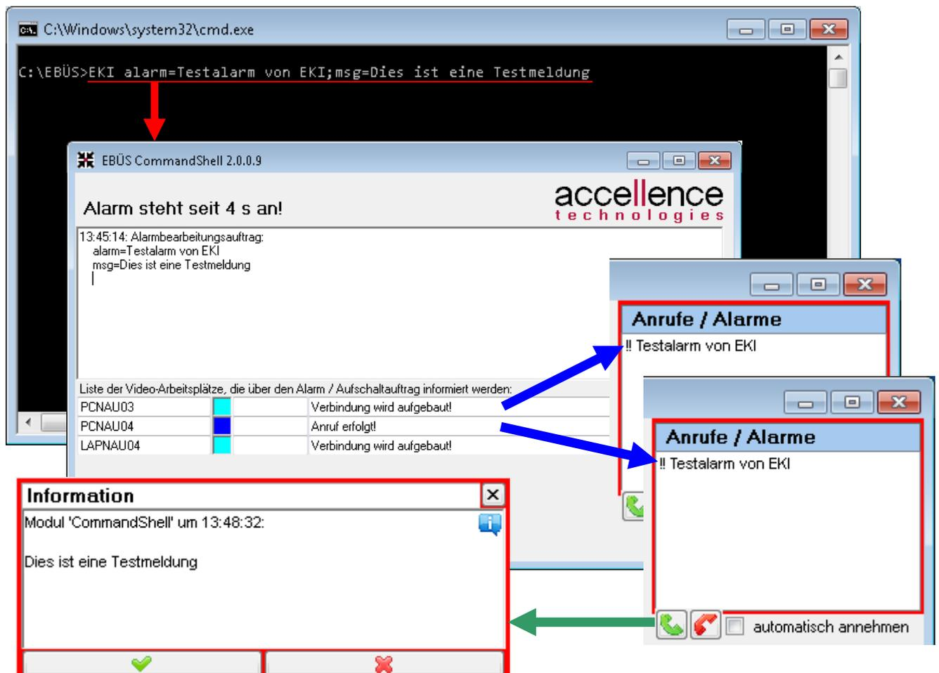
The screenshot illustrates the execution of a command in a Windows command prompt. The command entered is: `EKI alarm=Testalarm von EKI;msg=Dies ist eine Testmeldung`. This command is processed by the EBÜS CommandShell 2.0.0.9, which displays a confirmation message: "Alarm steht seit 4 s an!".
